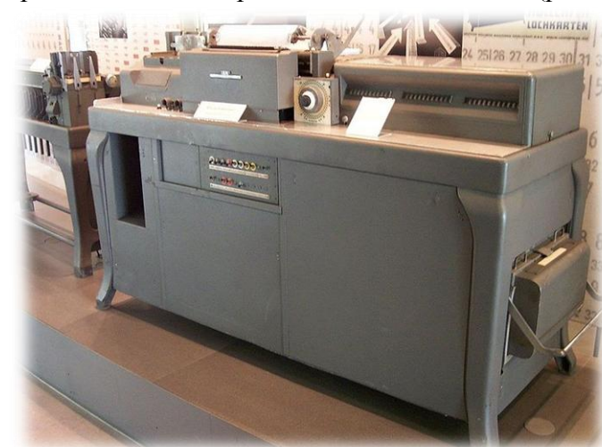
Obr.4 Sčítací stroj na děrné štítky
